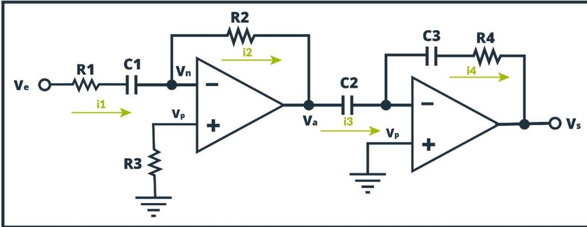
En este caso tenemos un sistema de dos etapas, representadas por  $\Delta_1 = \left[ \frac{V_a(s)}{V_e(s)} \right]$  y  $\Delta_2 = \left[ \frac{V_s(s)}{V_a(s)} \right]$ , de tal forma que, para obtener la función de transferencia del sistema, tenemos que  $\Delta = \Delta_1 * \Delta_2$ , quedando de esta forma:
