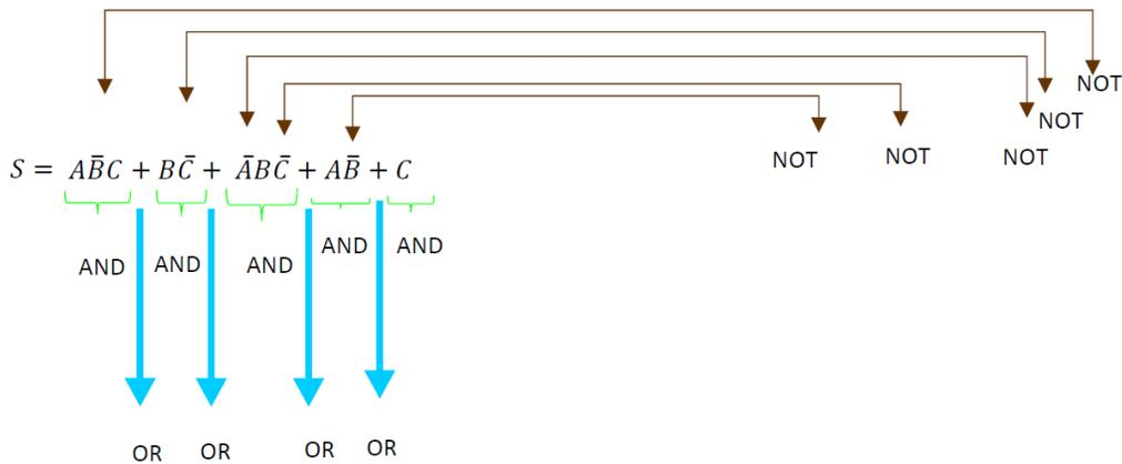
En este ejemplo, como vemos en la función a resolver, se tienen 5 compuertas AND, 4 compuertas OR y 5 compuerta NOT, se utilizarán los teoremas del álgebra de Boole para simplificar esa función y posteriormente poder armar el circuito.
