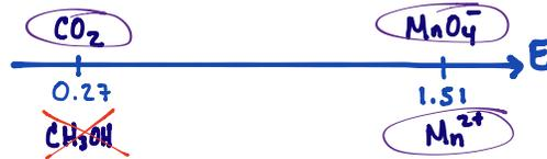
El (E) lo impone el par  $\text{MnO}_4^-/\text{Mn}^{2+}$  (Un par redox)
